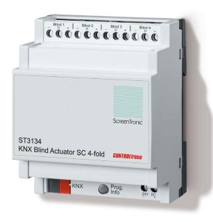
Der KNX Jalousieaktor SC wurde speziell für die Ansteuerung von Jalousien im Isolierglas entwickelt. Er ist für die Steuerung von 24V SC Motoren über eine 3-polige Anschlussleitung vorgesehen. Je Ausgang am Aktor wird eine Jalousie angeschlossen, die über zwei Adern mit Spannung versorgt wird und über die dritte Ader sehr präzise individuell gesteuert werden kann.
